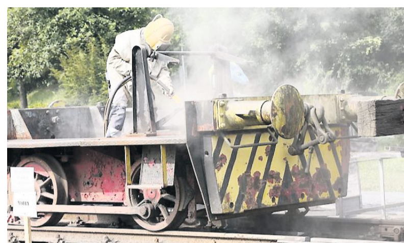
Stefan Michel beseitigt mithilfe eines Sandstrahls die verblasste Farbe und rostige Stellen.
